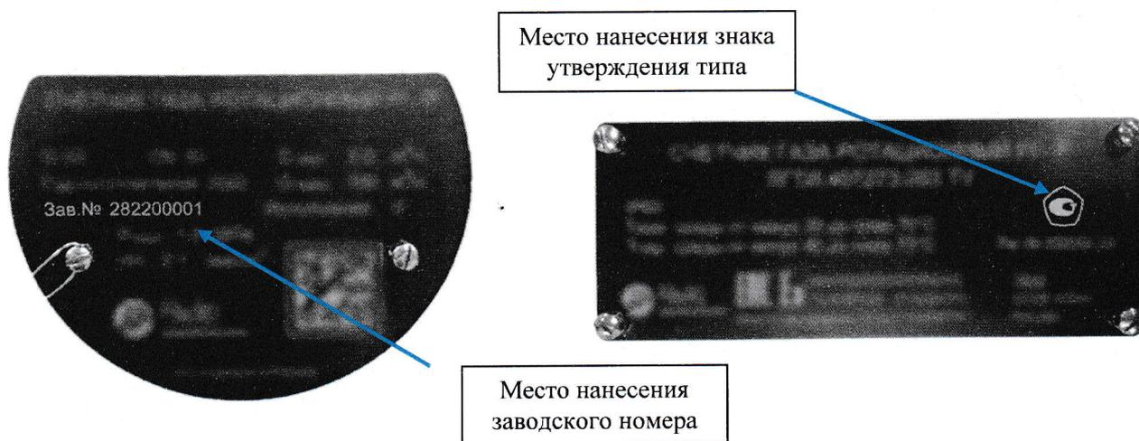
Рисунок 2 – Места нанесения заводского номера, знака утверждения типа
