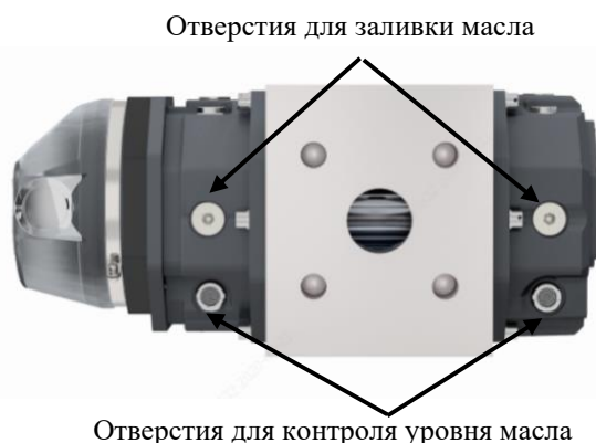
Рисунок 23. Заливка и контроль уровня масла при установке счетчика G10-G400 на горизонтальном участке трубопровода
