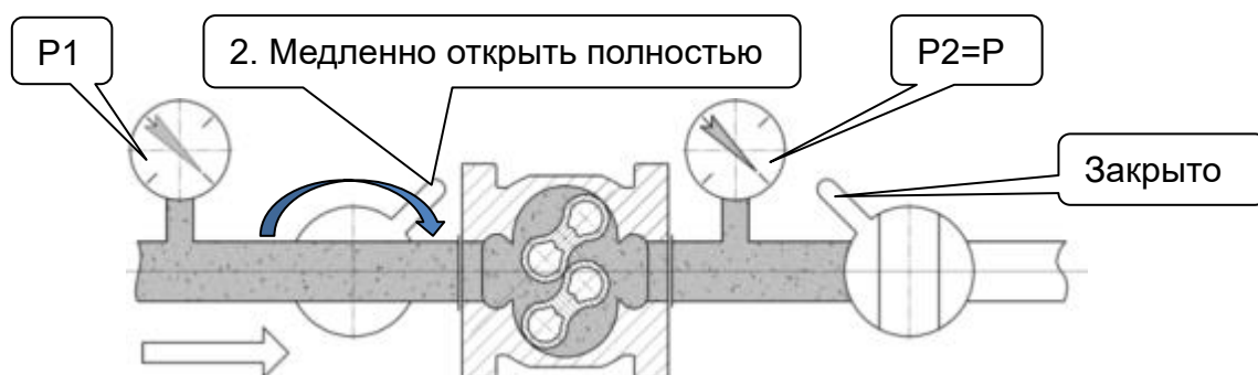
Рисунок 6. Полное открытие запорного устройства до счетчика
